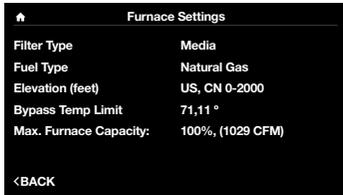
**Bypass Temp Limit (Limite de température de dérivation)** – La température maximale de la température de l'air sortant pendant que le système est en dérivation. Si la limite est dépassée, le système pourrait s'éteindre et déclencher l'alerte T027\_Z de limite de température d'alimentation dépassée à la dérivation.
