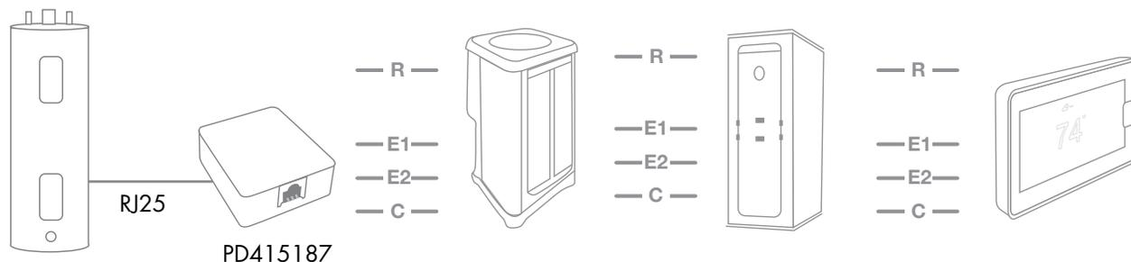
Exemple de connexion du thermostat intelligent avec l'unité CVC et le chauffe-eau. Veuillez noter que ceci n'est qu'un exemple et que le réseau de commande peut changer tant qu'il est en chaîne de marguerite.
