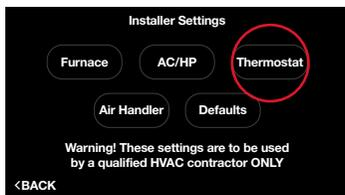
Statut du thermostat (Menu > Settings [Paramètres] > Installer [Installateur] > Thermostat)
