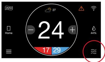
Sélectionnez l'icône du mode au coin droit inférieur de l'écran d'accueil pour changer rapidement le mode de fonctionnement.
