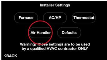
Statut du système de traitement d'air (Menu > Settings \ [Paramètres] > Installer \ [Installateur] > Air Handler \ [Système de traitement d'air])
