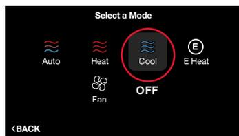
**Cool (Climatisation)** – Met la climatisation en marche lorsque la température actuelle grimpe au-dessus de la température de votre point de consigne. Si le thermostat demande activement la climatisation, les mots « Cooling To (Refroidir jusqu'à) » apparaîtront au-dessus du point de consigne de climatisation.
