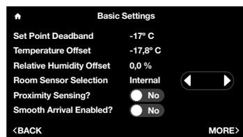
Menu > Settings (Paramètres) > Basic (de base) > Room Sensor Selection (Sélection du capteur de température ambiante).
