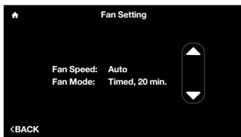
**Fan Mode (Mode du ventilateur)** – Cette caractéristique vous permet de déterminer la durée de marche minimum du ventilateur du système par heure. Le défaut est continu et le ventilateur marchera constamment entre les appels de chaleur et de climatisation. Vous pouvez régler la durée de marche minimum du ventilateur à entre 10 et 40 minutes par heure. La durée de marche du ventilateur s'applique pendant n'importe quel mode choisi, sauf si le système est éteint.
