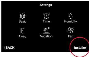
Pour avoir accès au menu Installer Settings (Configurations de l'installateur), sélectionnez Menu > Settings (Configurations), puis touchez et maintenez le contact sur « Installer (Installateur) » dans le coin droit inférieur de l'écran pendant cinq secondes.
