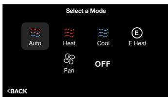
Sélectionnez parmi Auto (Automatique), Heat (Chauffage), Cool (Climatisation), E-Heat (Chauffage d'urgence), Fan (Ventilateur) et Off (Arrêt).
