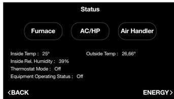
Sélectionner Furnace (Fornaise), Air Handler (Centrale de traitement d'air) ou AC/HP (Conditionneur d'air / PAC) sur l'écran de statut affichera le statut de chaque pièce d'équipement actuellement en cours de fonctionnement ainsi que les cycles et durées de fonctionnement historiques.
