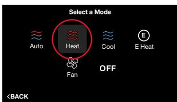
**Heat (Chauffage)** – Met le chauffage en marche lorsque la température actuelle tombe en dessous de la température de votre point de consigne. Si le thermostat demande activement le chauffage, les mots « Heating To (Chauffer jusqu'à) » apparaîtront au-dessus du point de consigne de chauffage.
