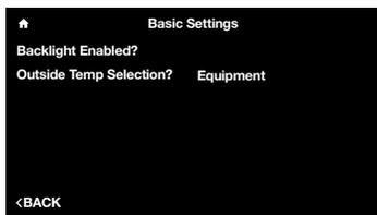
**Outside Temp Selection (Sélection de la température extérieure)** – La sélection détermine l'origine de la température extérieure qui sera affichée sur l'écran d'accueil. Choisissez entre l'Internet et l'équipement.
