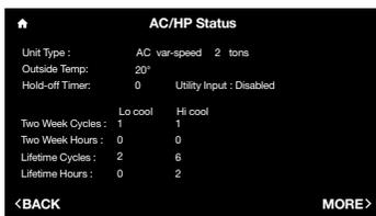
Statut du conditionneur d'air/de la pompe à chaleur (Menu > Status \[Statut] > AC/HP \[Conditionneur d'air/Pompe à air])
