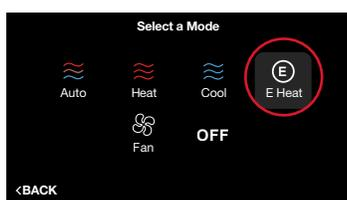
**E-Heat (Chauffage d'urgence) (Systèmes de pompe à chaleur uniquement)** – L'option de chauffage d'urgence est une configuration manuelle, non pas une fonction automatique initiée par le thermostat de la pompe à chaleur. L'objet de la configuration de chauffage d'urgence est d'amener la source de chaleur de secours en ligne immédiatement pour assurer 100 % des besoins de chauffage de la maison tout en verrouillant simultanément la pompe à chaleur.
