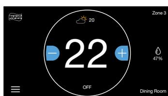
Si vous avez un **système de zonage EcoNet** et que le point de consigne de chauffage de la commande de zone EcoNet est réglé sur 10 °C (50 °F) ou le point de consigne de climatisation est réglé sur 33 °C (92 °F), la commande de zone passera par défaut à **Off (Arrêt)**.
